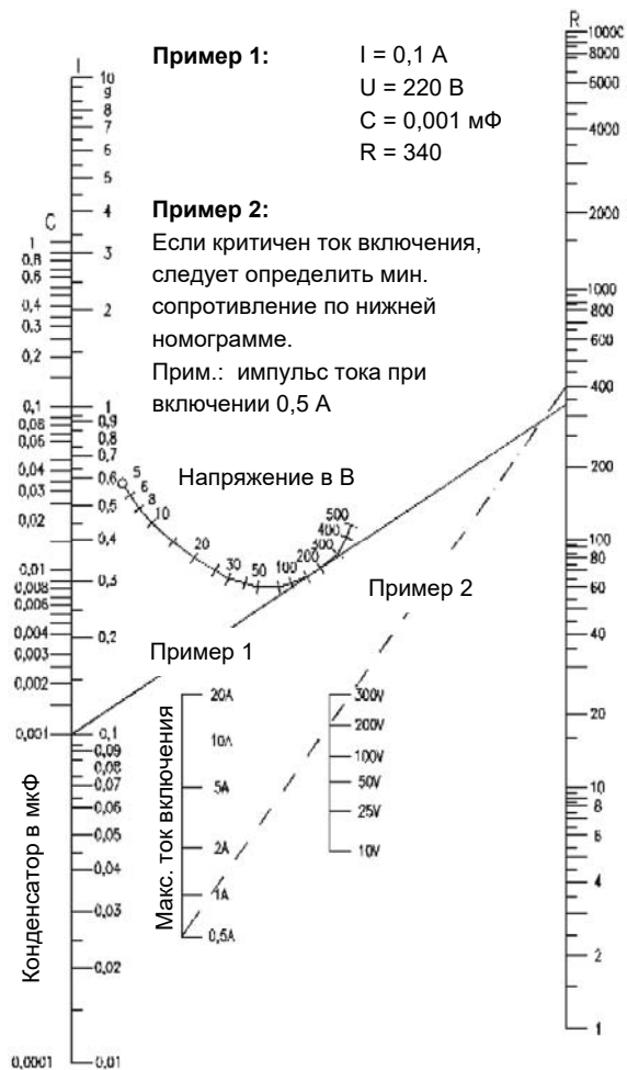
Рис. 6. Номограмма для определения гашения контактной дуги при индуктивной нагрузке
