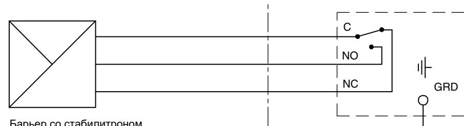
Рис. 6. Эксплуатация реле давления в искробезопасных зонах
